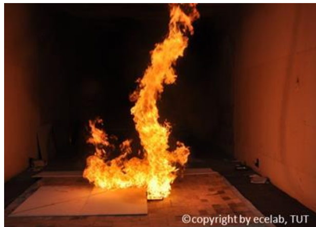
建築研の大型火災風洞内での模型実験
